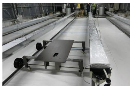
性能評価では温室屋根材（SMAP パネル）の温度放熱特性は確認できた。半面、熱貫流率性能が良く保温性が高いことから夏場の高温対策が必要である。
