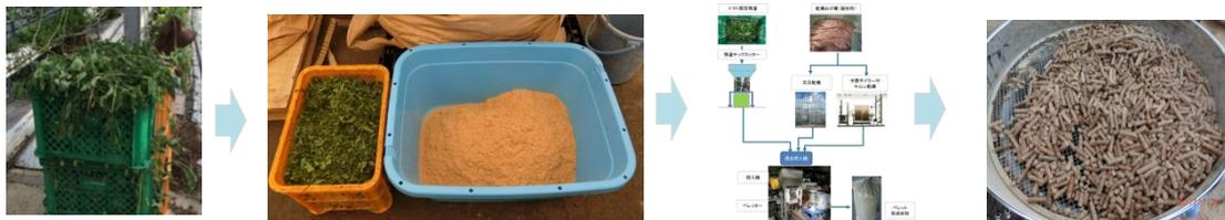
トマト残渣のチップカットとペレット成型とペレットボイラーで温室の暖房での栽培と循環型再生可能エネルギーの開発が実現できた。今後はペレット製造プロセスの実用化へ展開する。更に複数の施設園芸事業者やペレットメーカーも参加するエネルギーセンター構想の参考とする。
